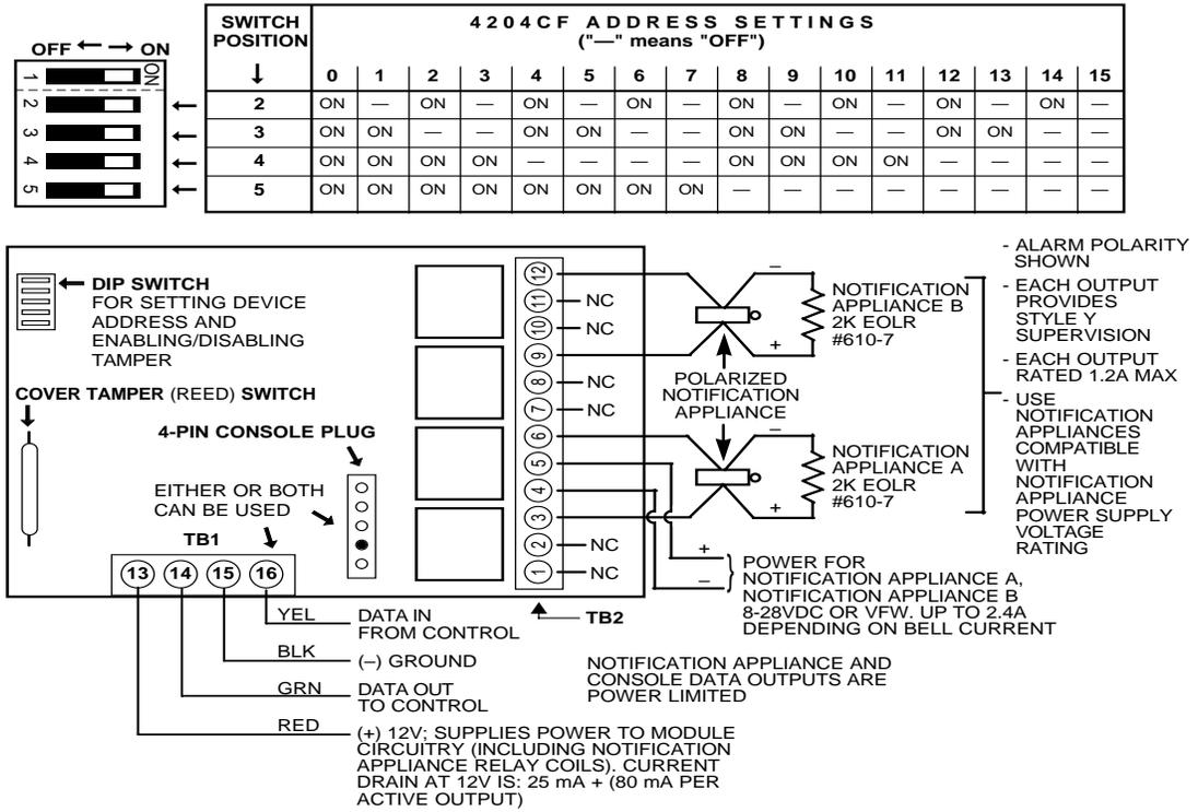
Figure 9-1b: 4204CF Relay Module
